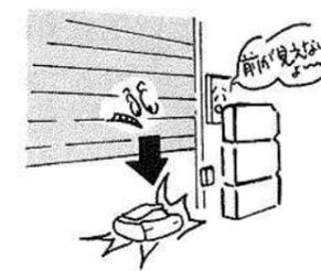
押しボタンスイッチまたは手動閉鎖装置の周りには、障害物を置かないで下さい。手動閉鎖装置は、いつでも操作できる状態にしておいて下さい。
