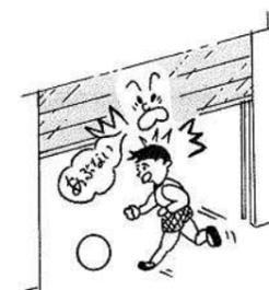
開閉操作する前に、物が置いてないか、人の出入りがいないか、必ず確認して下さい。特にお子様の飛び出しなどに注意して下さい。
